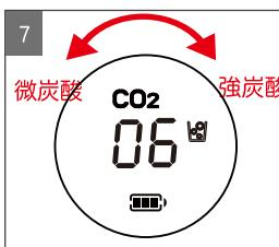
マシンヘッドの炭酸濃度調節レバーを回してお好みの炭酸の強さを設定します。
