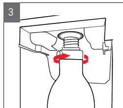
シリンダーバルブを取り付け部の溝に合わせて時計回りに回して炭酸ガスシリンダーをセットしてください。
