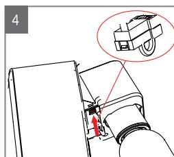
マシンヘッドの下のレバーを引きながら引っ張ると本体内部のパーツが外れます。
