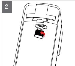
シリンダー取り付け部にセットされているパッキン落下防止キャップを反時計回りに回して外してください。
