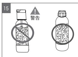
できあがった炭酸飲料はインフューザーをふた代わりにせずにボトルキャップをしっかりととはめて冷蔵庫で保管してください。
