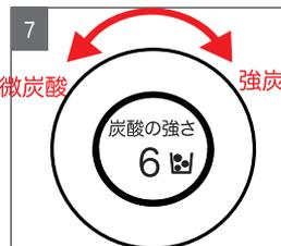
マシンヘッド上部の炭酸濃度設定レバーを回して好みの炭酸強度を設定する。「1」微炭酸から「6」強炭酸までの設定が可能です。
